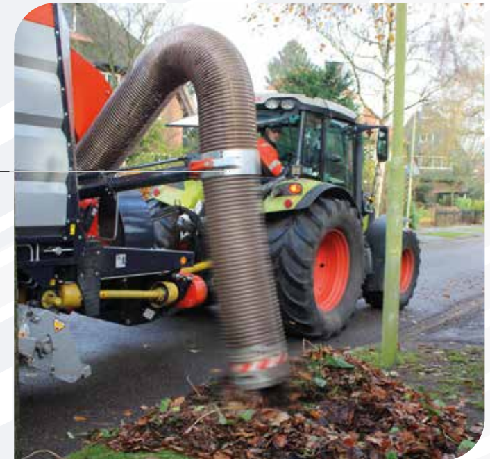
Bedienung des Saugschlauchs mit der Joysticksteuerung.
