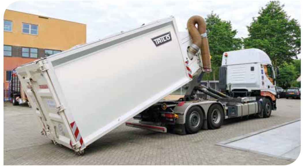
Einfaches Auf- und Abladen mit einem Hakenliftsystem.
