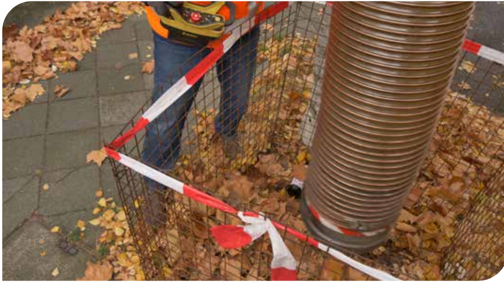
Eine Pendelautomatik bewegt den Saugschlauch hin und wieder, damit ein Schwad besser abgesaugt wird.
