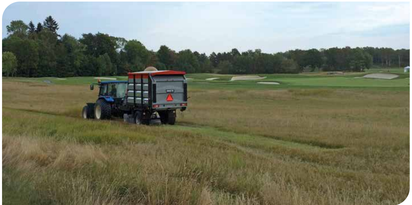
Eine TRILO C8 Mähen und sammeln Große Saugwagen mäht und sammelt 'the Rough' in einem Arbeitsgang.
