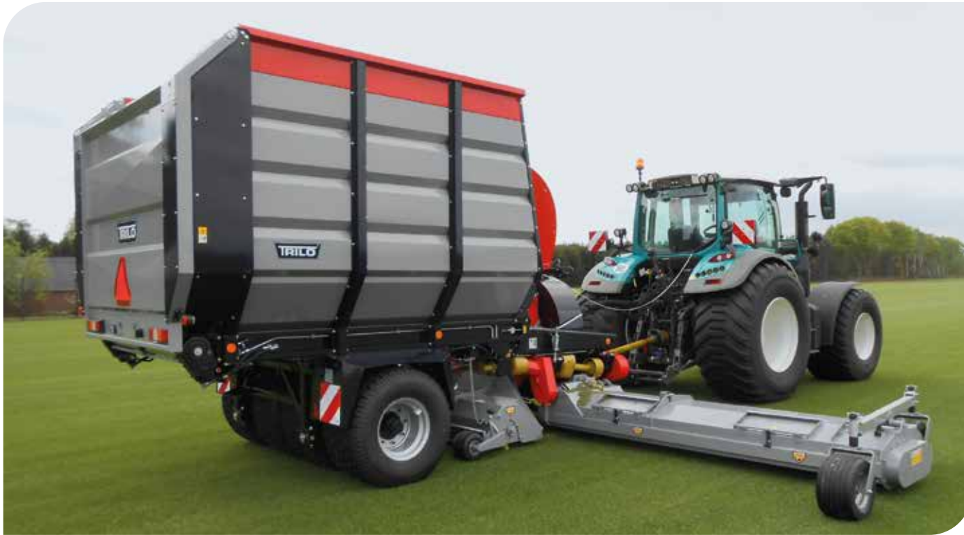
Große Kehrsaugwagen mit Seitenauslegern zum Aufsammeln von Grasresten oder vertikutier Rückständen von großen Flächen.
