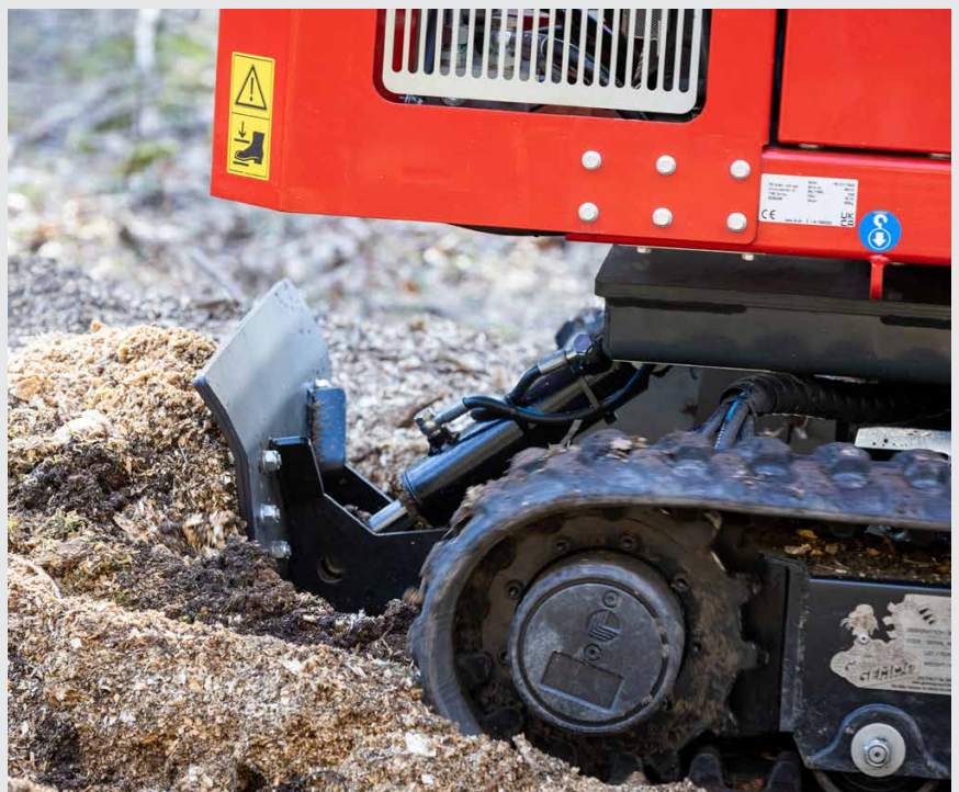
Der optionale Planierschild erleichtert das Einebnen und Auffüllen des Bodens nach der Entfernung des Stumpfes und hinterlässt einen saubereren, professioneller aussehenden Arbeitsplatz.
