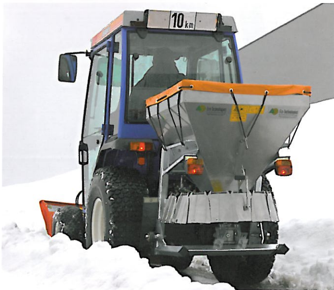
Tellerstreuer XTA-250 an Kompaktraktor im Einsatz
