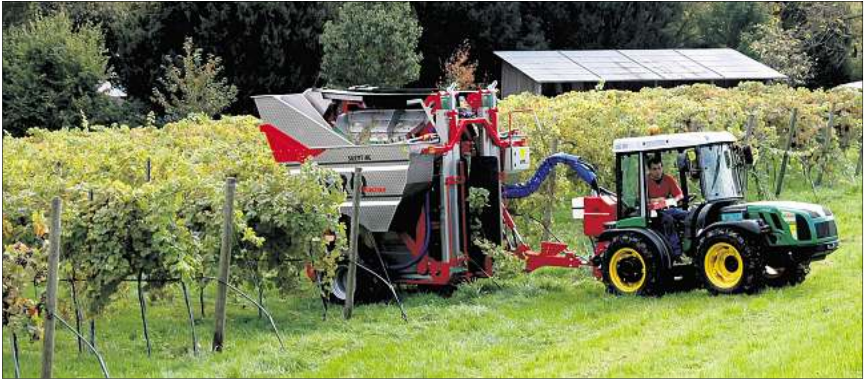
Der automatische Vollerter wird an einen Traktor angehängt. Er wird aber nicht gezogen, die Maschine verfügt über einen eigenen Antrieb. (Philipp Aeberli)
