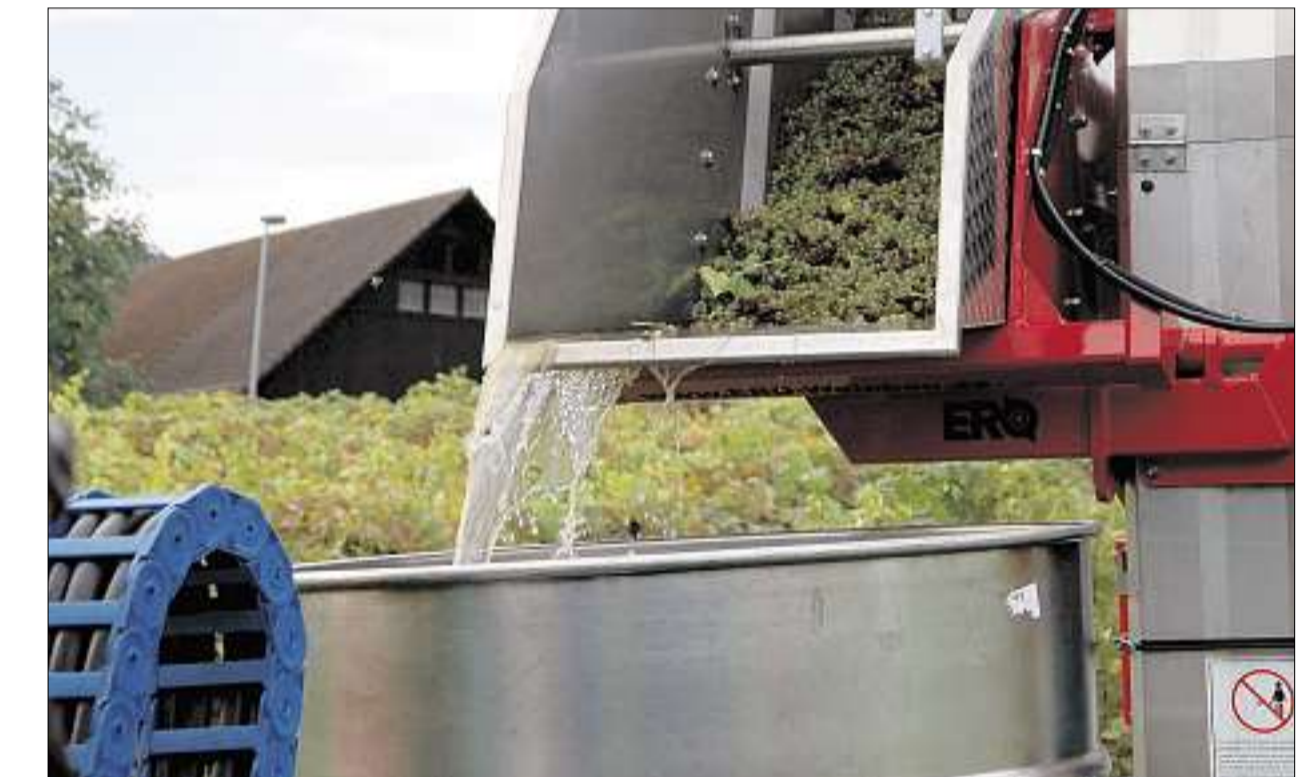
Einer der Behälter mit den gesammelten Trauben wird entleert. Die Maschine hat zwei solche Behälter, die je etwa 1200 Liter Volumen aufweisen.
